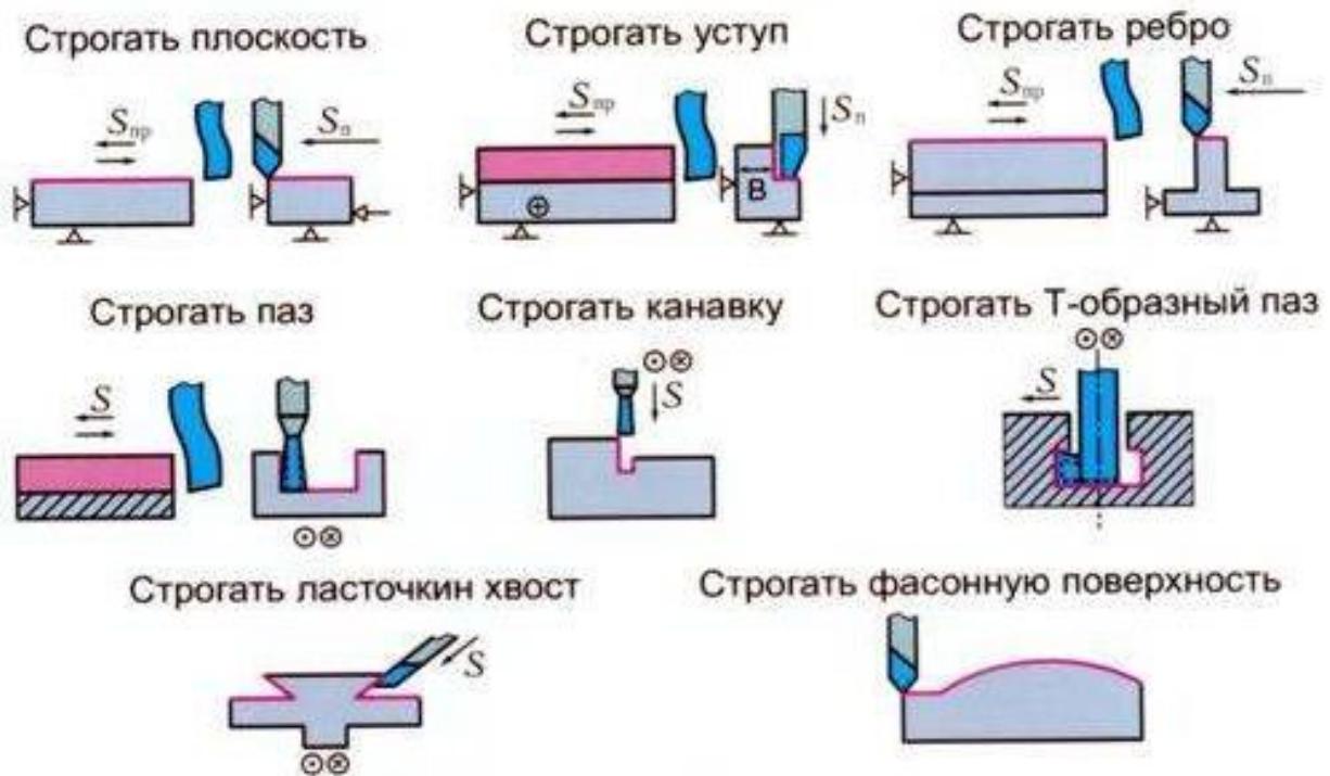
Рисунок 75 – Виды обработок на строгальном станке
