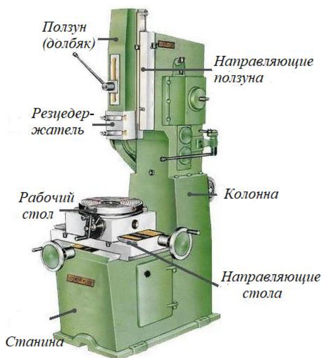
Рисунок 79 – Долбежный станок
