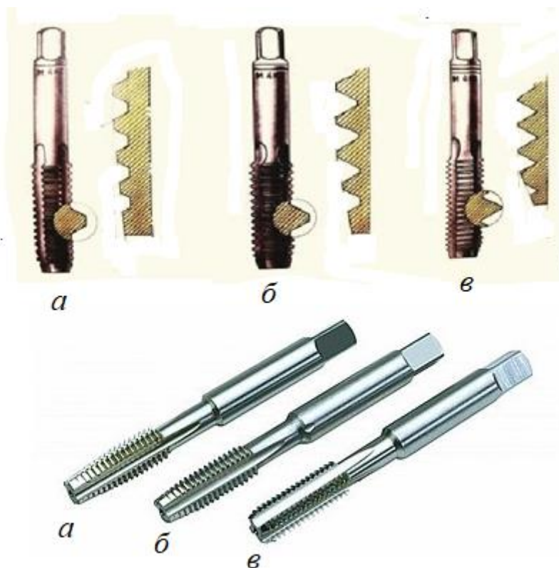
Рисунок 145 – Комплект метчиков: а – черновой; б – получистовой (средний); в – чистовой
